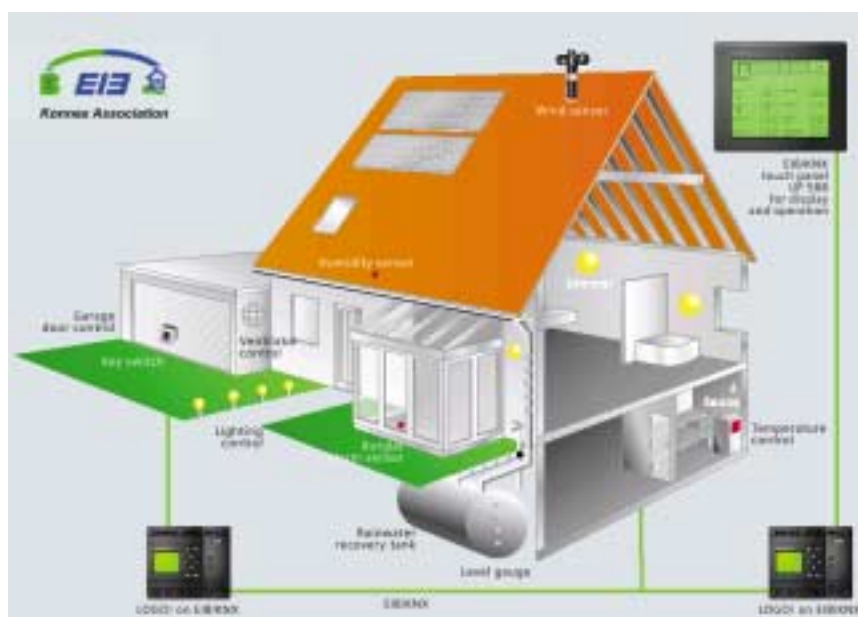
Rys 9 Przykład aplikacji wykorzystującej LOGO! z modułami KNX (EIB)
